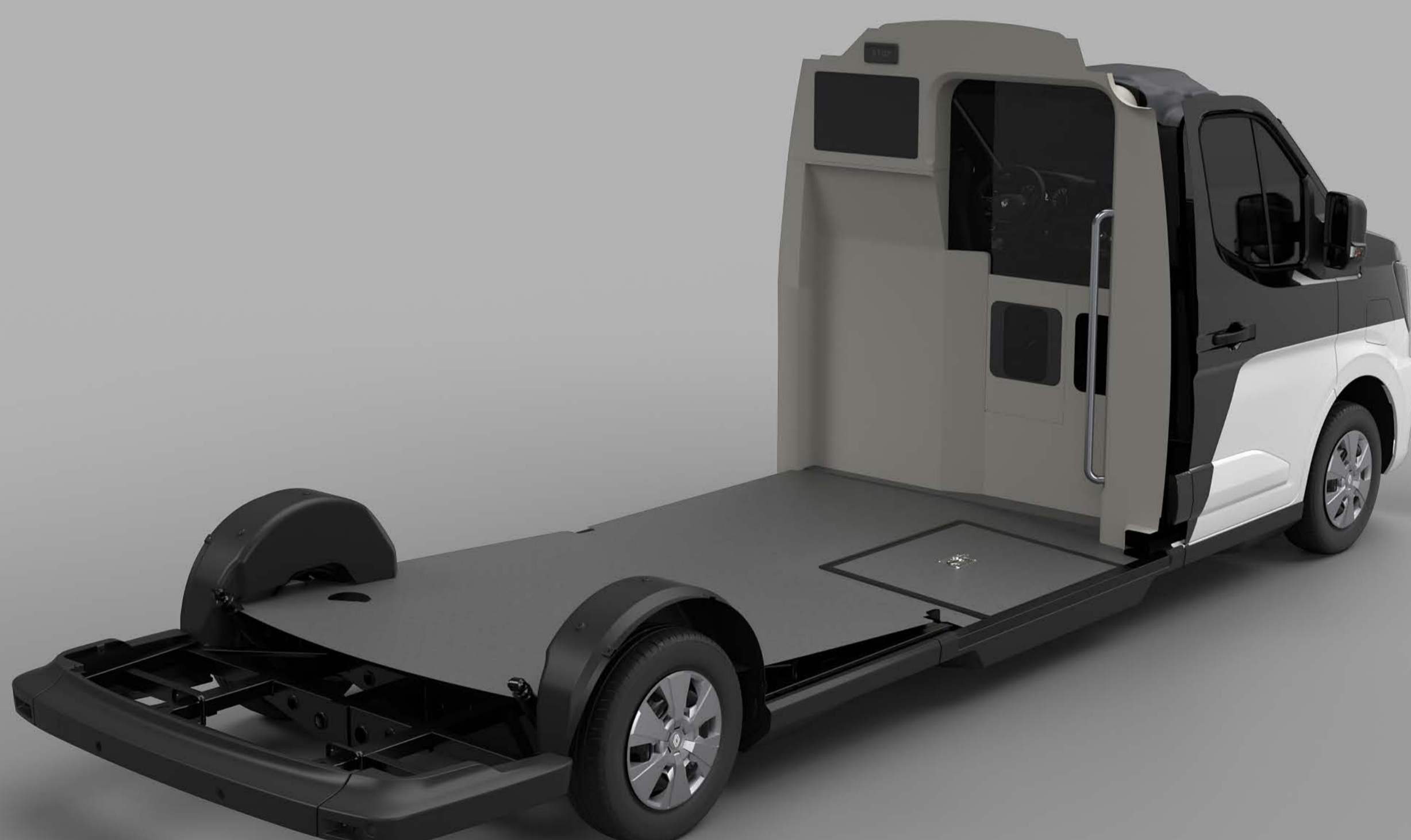
plancher bas intégral
